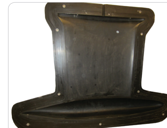
Precision keel mould
